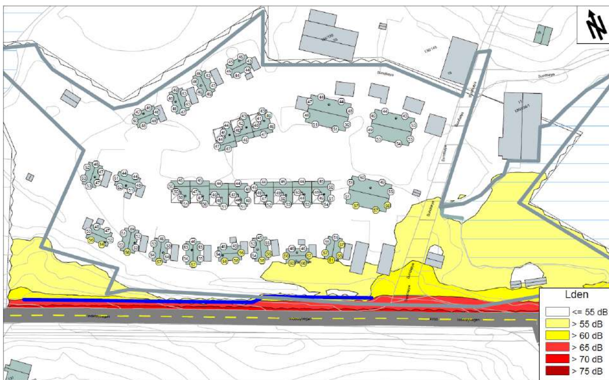
Figur 4. Beregnet støynivå L_{den} [dB] på uteoppholdsareal og ved fasade (høyeste nivå uavhengig av etasje), beregningshøyde uteoppholdsareal 1,5 m. Skjermingsforslag sør for tomt (blå strek): Skjermhøyde 1,8 m.
