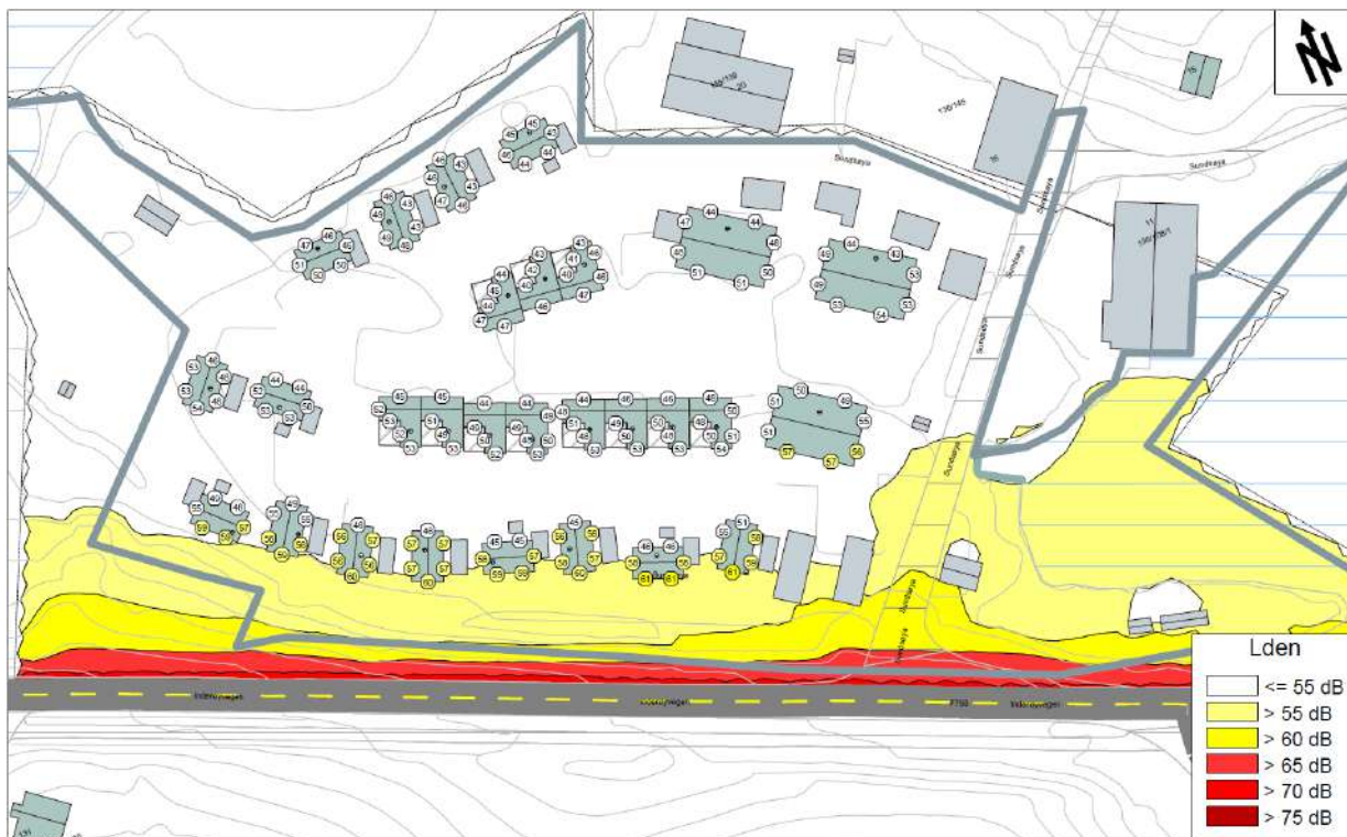
Figur 3. Beregnet støynivå L_{den} [dB] på uteoppholdsareal og ved fasade (høyeste nivå uavhengig av etasje), beregningshøyde uteoppholdsareal 1,5 m.
