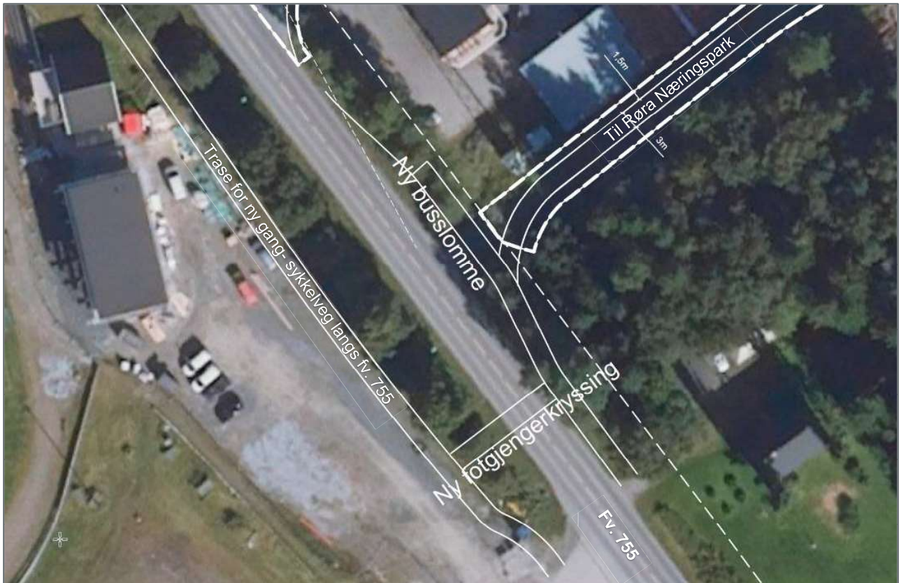
Figur 4-6: Detaljutsnitt som viser løsning mot fv. 755 med foreløpig skissert busslomme og krysningspunkt over fv. 755
