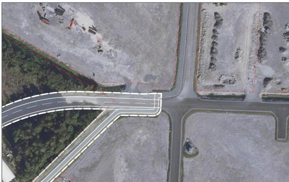
Figur 4-7: Detaljutsnitt som viser krysningspunkt for gang- sykkelveg over Søndre Lensmyrvegen
